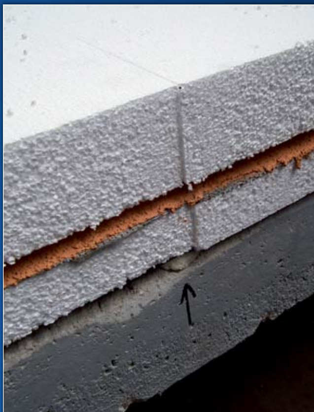
Dynamická zkouška sání větru zdvojeného zateplovacího systému za extrémních podmínek
